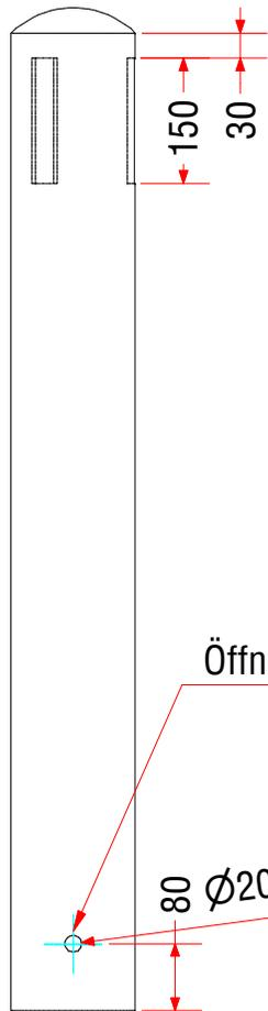
Öffnung für Torstahl zum einbetonieren
