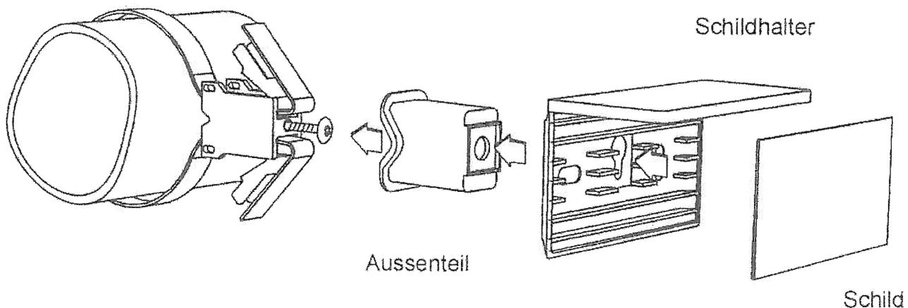
Anschließend das Außenteil auf das Innenteil stecken. Das Befestigungsloch des Schildhalters auf den Schraubenkopf setzen. Außenteil mit Schild positionieren und anschließend festschrauben. Dadurch wird das Spannband automatisch gestrafft.
