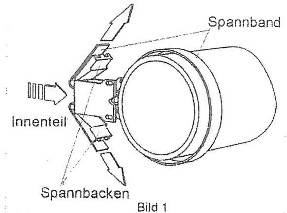
Beide Spannbacken des Innenteiles
