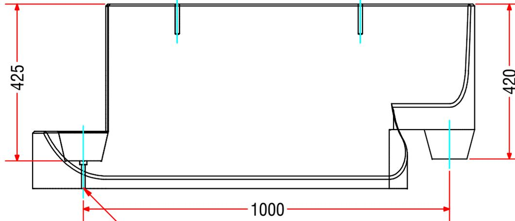
Schrauböffnung für baus. Verschrauben mit Kunststoffdübel M16 und Edelstahlschraube M12x200 DIN 571
