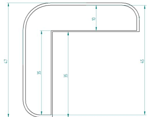
Dieses Produkt stellt eine sinnvolle Ergänzung zu dem Knuffi® Warn- und Schutzprofil Typ H dar. Die Endkappe ermöglicht eine Abdeckung der offenporigen Schnittkanten des Polyurethanschaum-Profilkörpers.
