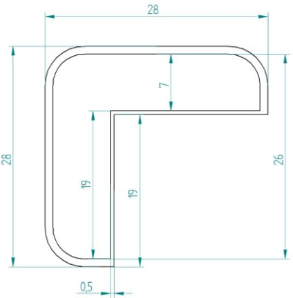
Dieses Produkt stellt eine sinnvolle Ergänzung zu dem Knuffi® Warn- und Schutzprofil Typ E dar. Die Endkappe ermöglicht eine Abdeckung der offenporigen Schnittkanten des Polyurethanschaum-Profilkörpers.
