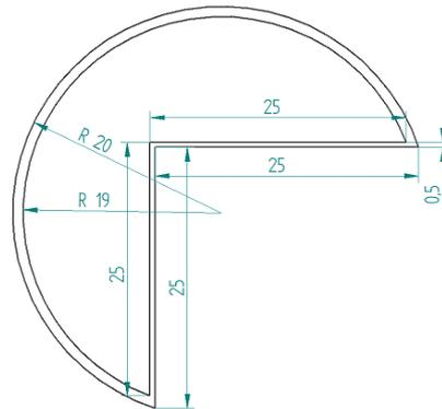
Dieses Produkt stellt eine sinnvolle Ergänzung zu dem Knuffi® Warn- und Schutzprofil Typ A dar. Die Endkappe ermöglicht eine Abdeckung der offenporigen Schnittkanten des Polyurethanschaum-Profilkörpers.
