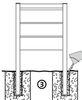
Funktionsprobe bei LED-Beleuchtung durchführen. Der Zwischenraum zwischen Säule und Leerrohr wird mit Beton oder Splitt zur Hälfte gefüllt. Dann den Aufsteller nochmals ausrichten und anschließend den Zwischenraum komplett füllen.
