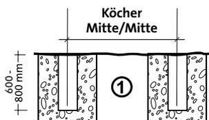
Fertiggestelltes, abgebundenes Köcherfundament aus Beton C20/25. Sie können den Aufsteller auch mit Standfüßen auf ein bereits vorhandenes, ausreichend dimensioniertes Fundament ausübeln.
