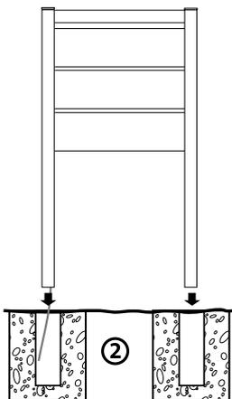
Fertig montierter Aufsteller wird in die Leerrohre gestellt und anschließend ausgerichtet. Bei Beleuchtung den E-Anschluss, wenn nicht anders festgelegt, im linken Köcher vorsehen. Das Kabel durch die Säule nach oben verlegen und durch die Kabelführung zur Beleuchtungseinheit ziehen und anschließen.
