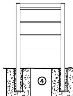
Aufsteller kann im komplett montierten Zustand nicht mehr entfernt werden. Bei einer Aufstellung mit Splitt ist ein Ziehen und Umsetzen der Schildpfosten möglich.
