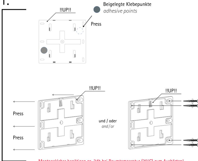
Montagekleber benötigen ca. 24h bei Raumtemperatur (20°C) zum Aushärten!
