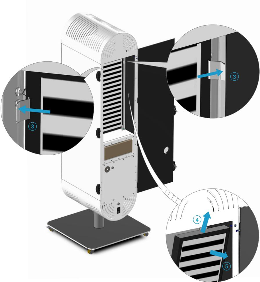
6. Neuen Vorfilter vorsichtig einsetzen und mit den Federelementen verspannen.
